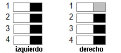
Posición para configuración con LCC-S
